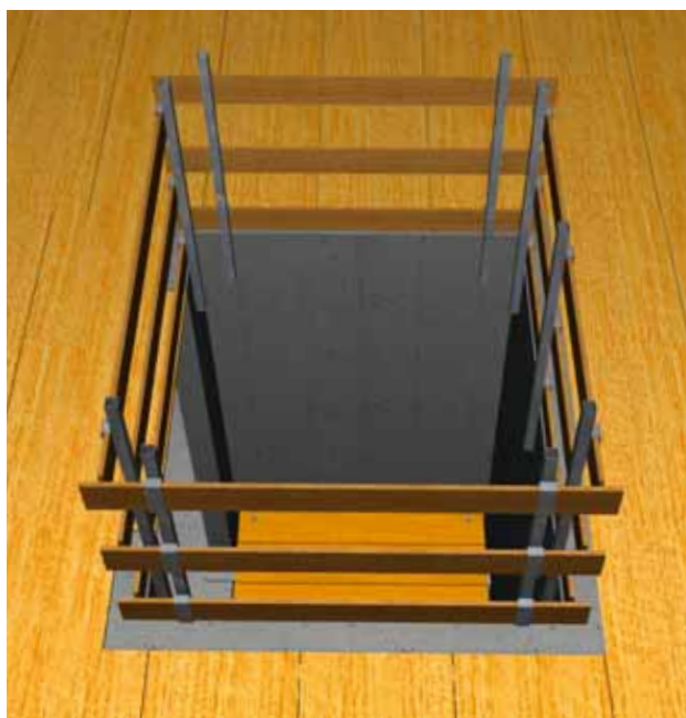
19 Una protezione laterale a 3 elementi impedisce la caduta nel vuoto per chi lavora presso l'ultima soletta.
