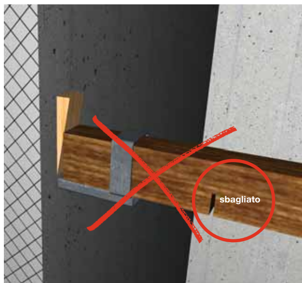
2 Travetto che presenta un danno meccanico. I travetti che presentano simili danni non devono essere assolutamente usati. Anche per i travetti corti occorre usare solo legno di qualità controllata.
