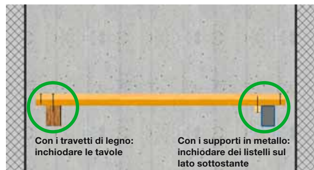
4 Come impedire lo spostamento delle tavole.
