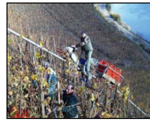
Fig. 2. Piccole cremagliere in uso nei vigneti della bassa Baviera
